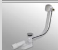
Odtoková souprava s napouštěním přepadem (napouštění 24 l/min – 3 bar, vypouštění 52 l/min)
