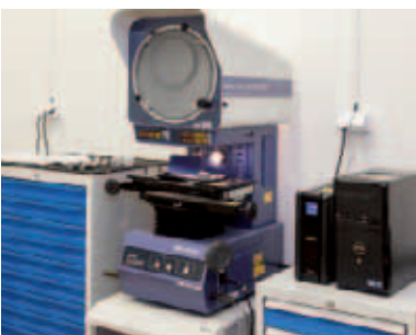
Profilový projektor. Laboratoř oddělení kvality.
