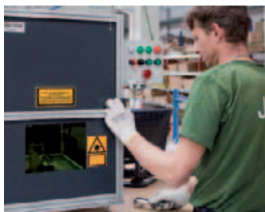
Laser při procesu vypalování loga.
