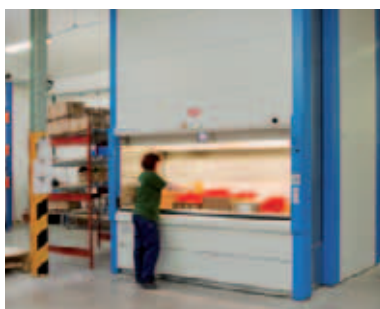
KARDEX. Velkokapacitní automatizovaný skladovací systém.
